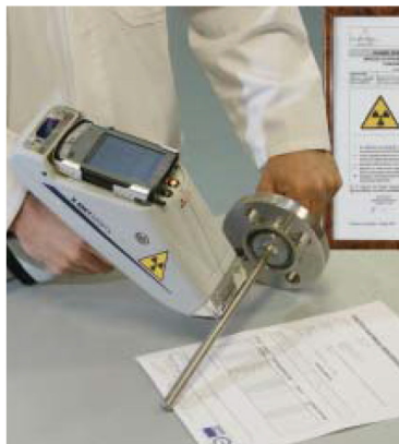
Identificación positiva del material (IPM) y control de la calidad por análisis visual
