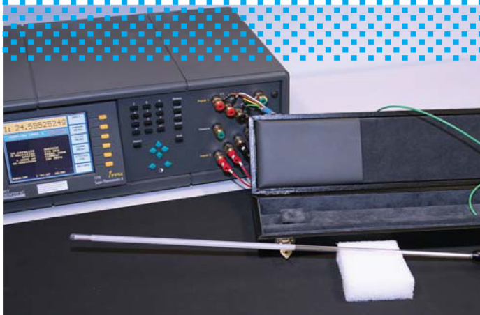
Termómetro de referencia calibrado ITS90, SPRT (Standard Platinum Resistance Thermo-meter, es decir, termómetro de resistencia de platino normalizado)
