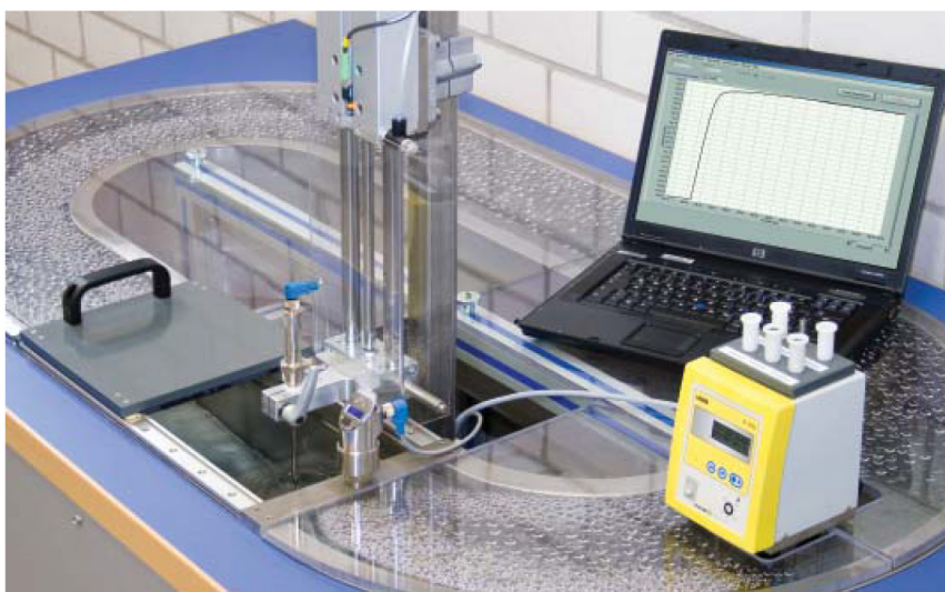
Comprobación del tiempo de respuesta de un sensor en un sistema con agua circulante
