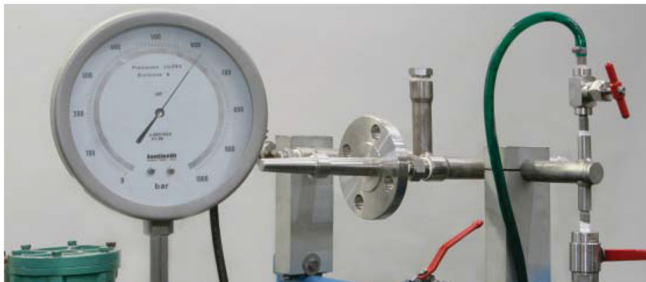
Prueba de ejecución a 900°C en un horno y prueba de presión hidrostática
