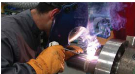
Soldadura con arco eléctrico cualificada
